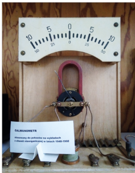
Galwanometr stosowany do pokazów na wykładach z chemii nieorganicznej w latach 1948–1968
