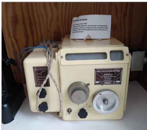
Fotokolorymetr stosowany do pomiarów absorbancji z kompensacją optyczną za pomocą wirującej tarczy; przystosowany w Katedrze Chemii Nieorganicznej do miareczkowań kolorymetrycznych, prod. Jouan, Paris, Francja, 1951
