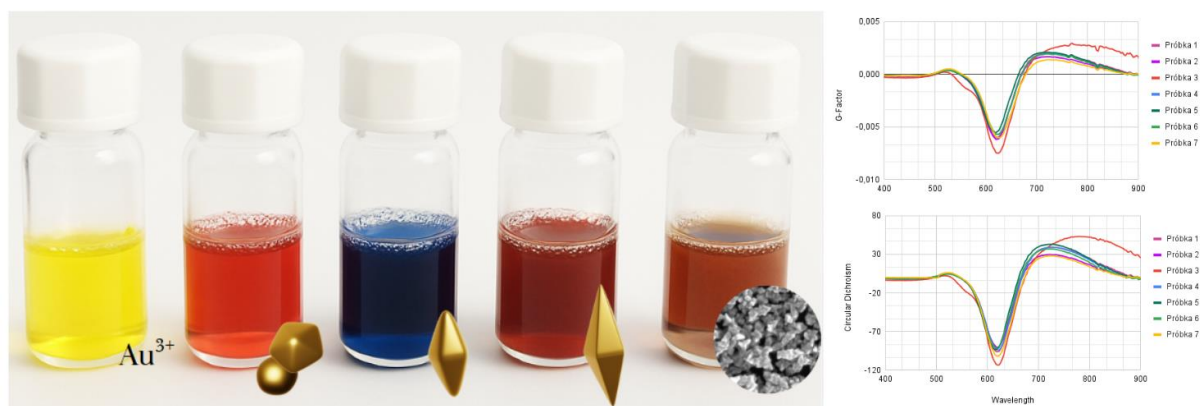
Schemat syntezy chiralnych bipiramid złota z uwzględnieniem zmian morfologii nanocząstek na poszczególnych etapach procesu.
