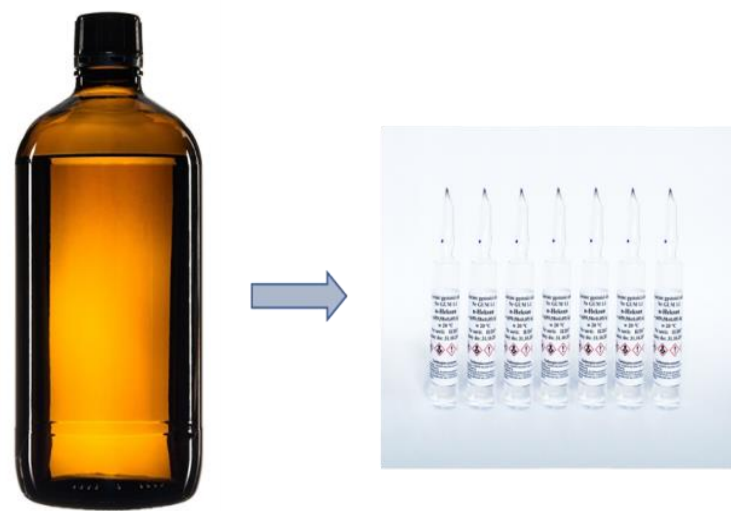
Schemat pobierania próbek przy wyznaczaniu stabilności długoterminowej materiału odniesienia.
