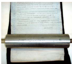
„Walek” – urządzenie do drukowania tekstów wyprodukowane na Wydziale Chemii z wykorzystaniem radzieckiego wałka do ciasta
